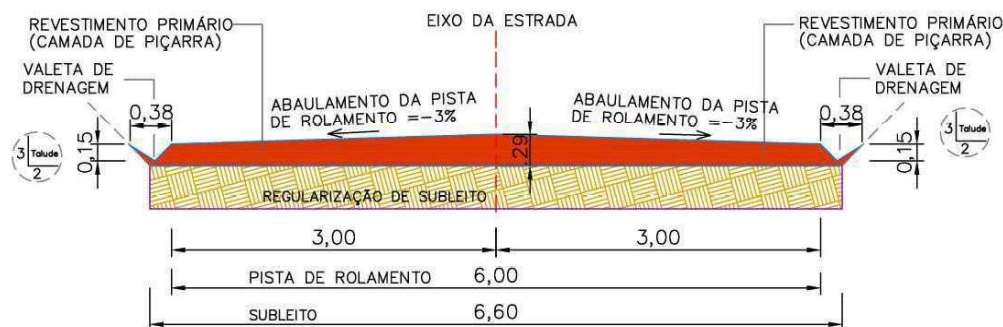
SEÇÃO TRANSVERSAL EM CORTE ESC. 1/50
