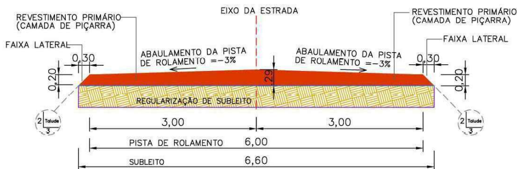
SEÇÃO TRANSVERSAL EM ATERRO ESC. 1/50
