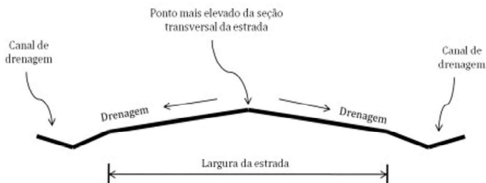
PERFIL TRANSVERSAL DE UMA ESTRADA COM SUPERFÍCIE ABAULADA
