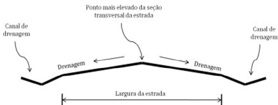
PERFIL TRANSVERSAL DE UMA ESTRADA COM SUPERFÍCIE ABAULADA
