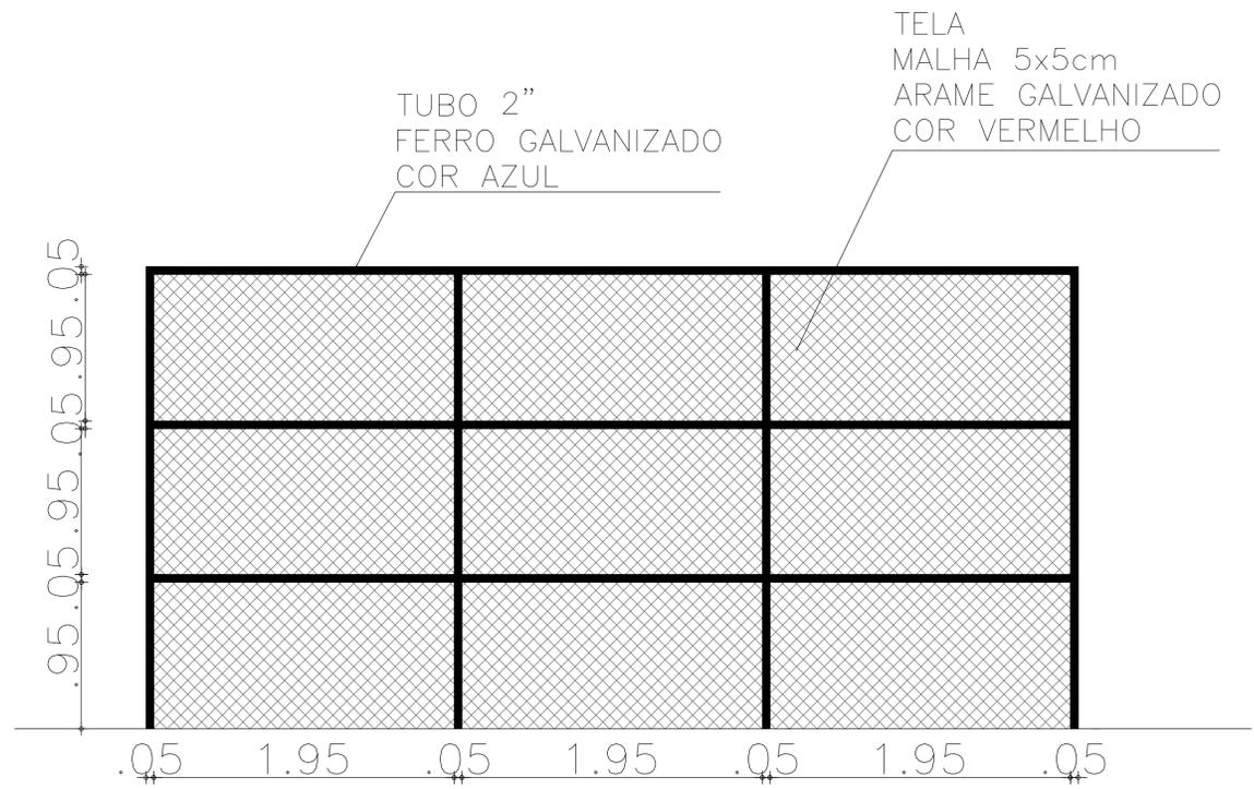
01 DETALHE ALAMBRADO ESC. 1/25
